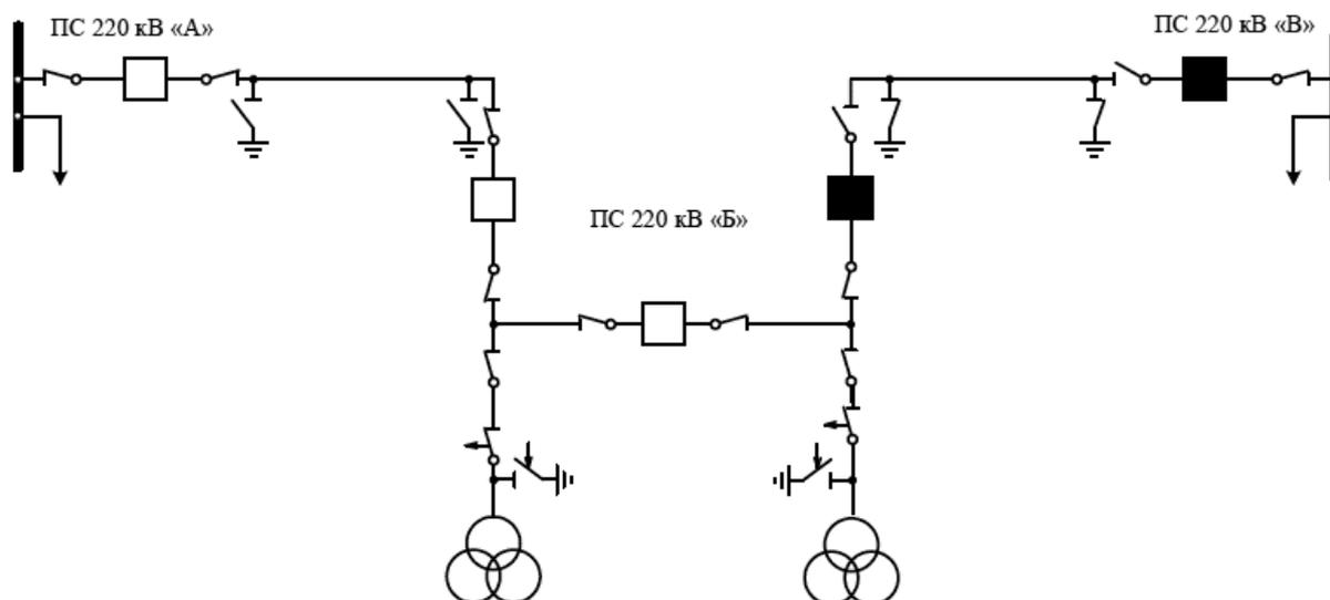
Рис.3. Схема участка электрической сети 220 кВ
